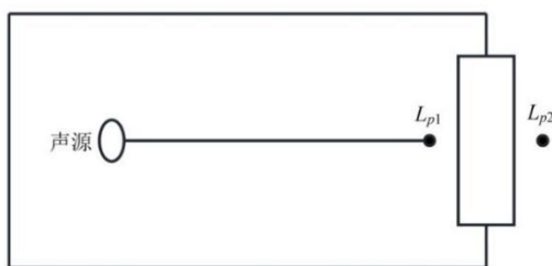
图 4-4 室内声源等效为室外声源图例
